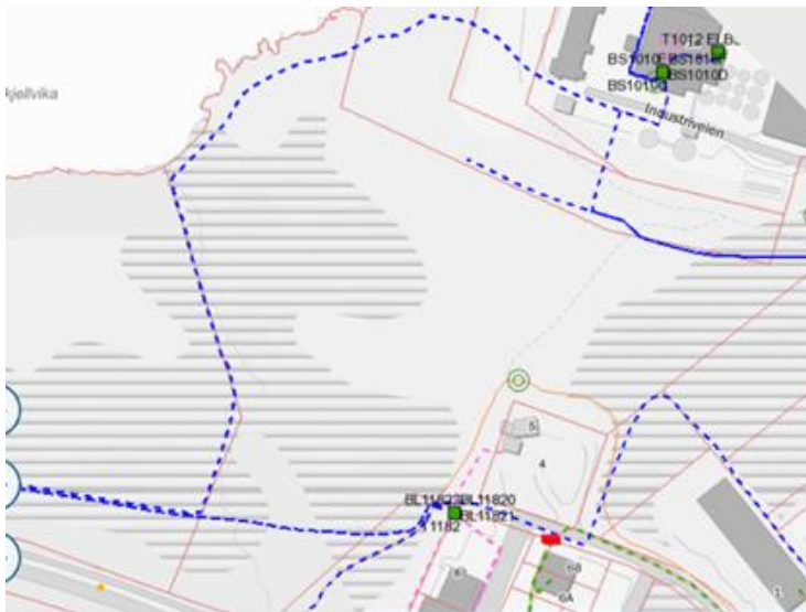
Oversikt over kabler til Trollfjord. Trafo i Rådmann Ribsskogs vei.
